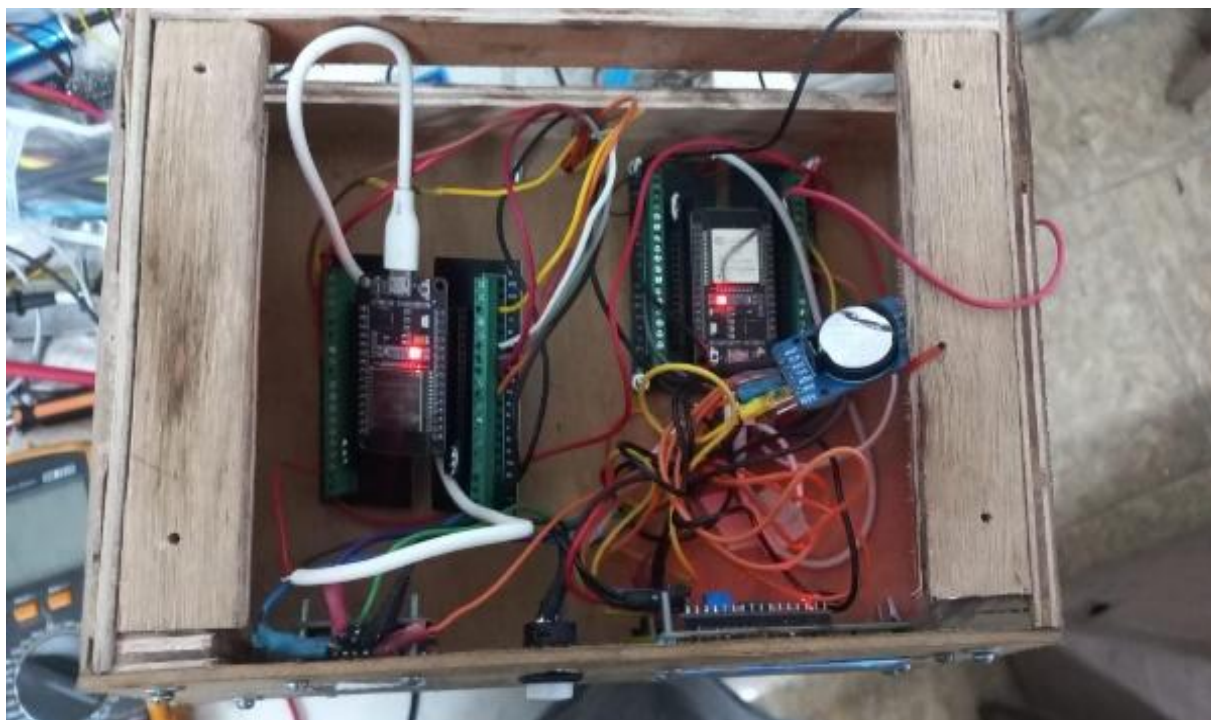
Figura 18 – ESP 32 à esquerda ESP Secundário e à direita ESP Principal.
