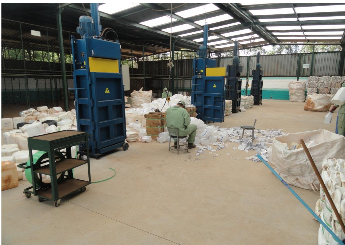
Figura 18. Colaborador retirando das embalagens rígidas laváveis as tampas, os lacres, os rótulos e as vedações de alumínio – ARIAR.
