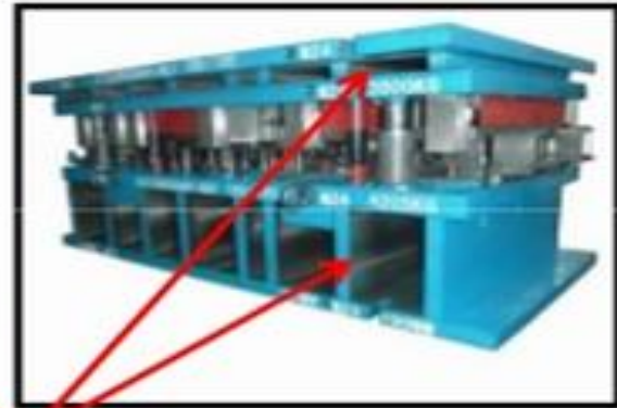
Ferramenta adaptada quanto a altura através de calço e sistema de fixação rápida através de clamps hidráulicos
