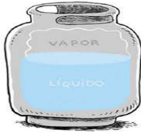
Figura 3: visão interna do botijão
