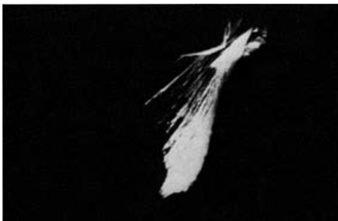
Figura 13 - Cristal de \text{CaCO}_3 modificado após interação com dispersante
