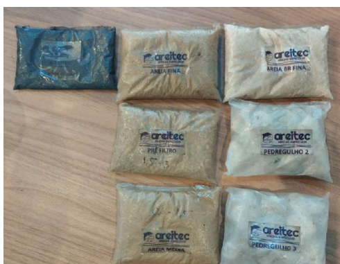
Imagem 17 - Materiais do filtro mecânico
