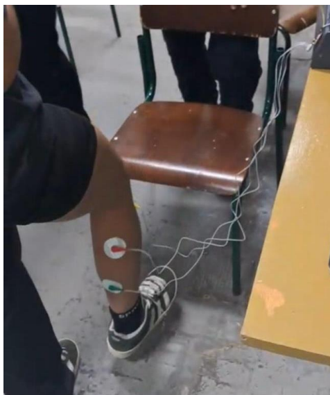
Figura 4 – Teste de funcionamento do sensor EMG
