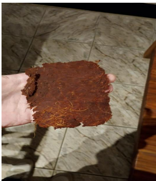
Figura 3 – Molde da embalagem feita a partir da fibra do coco.
