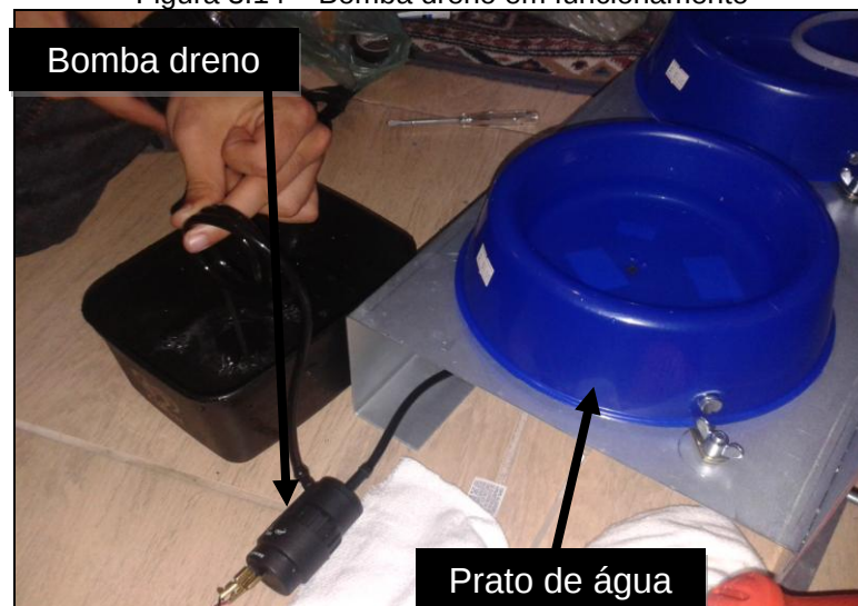
Figura 3.14 – Bomba dreno em funcionamento
