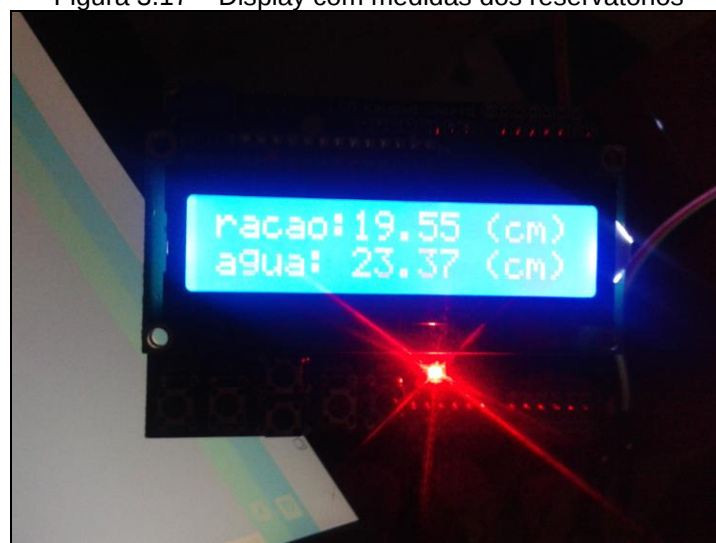
Figura 3.17 – Display com medidas dos reservatórios
