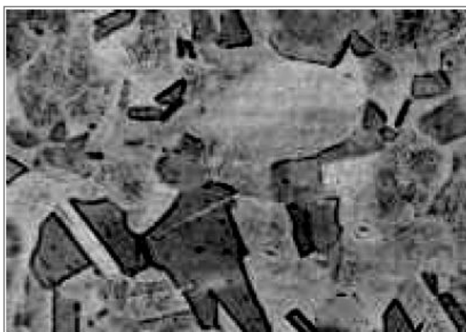
Figura 9: Estrutura Metalúrgica de um aço inoxidável austenítico. (Prof. Dr. Aílton Cavalli, Apostila Uni Anchieta, Materiais).
