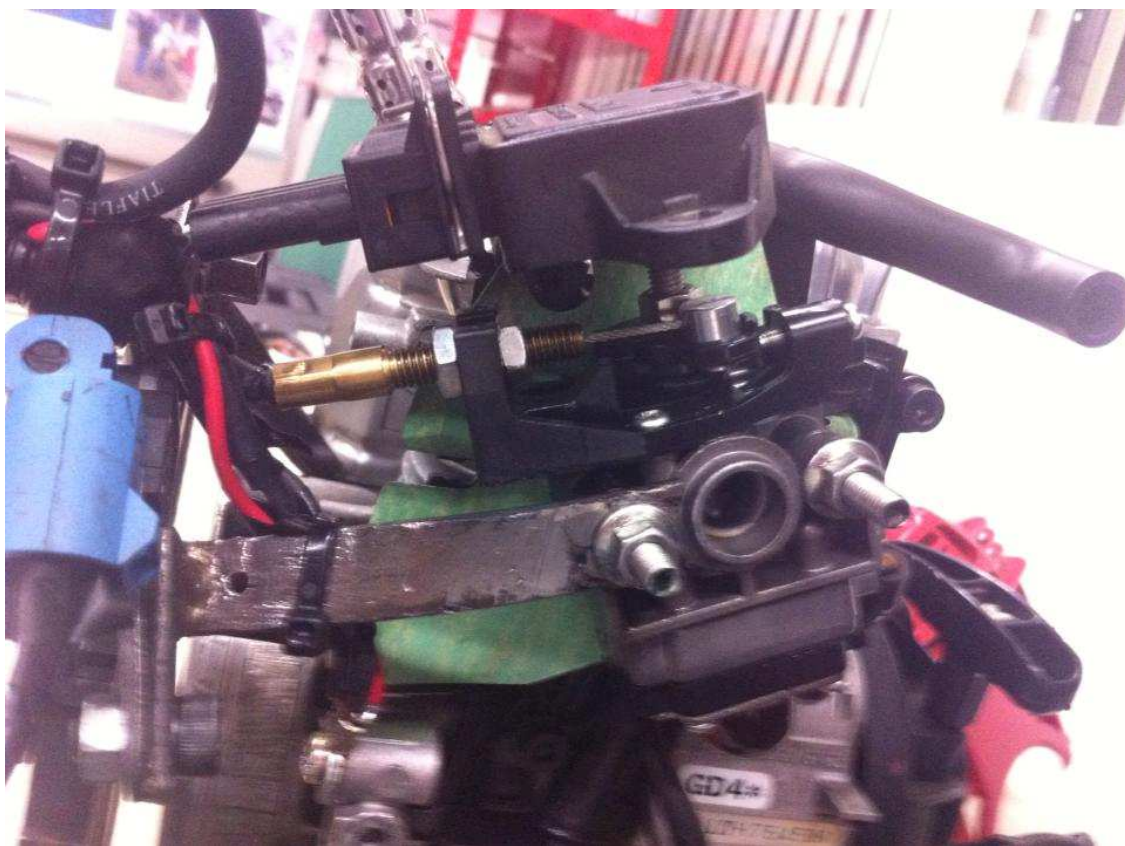
Figura 8 – Montagem do TPS (Fonte: Foto retirada da montagem do projeto).
