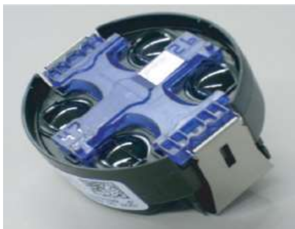
Figura 5 - Corpo de sensor de chuva - Extraída de (KATO e YAGI, 2008).
