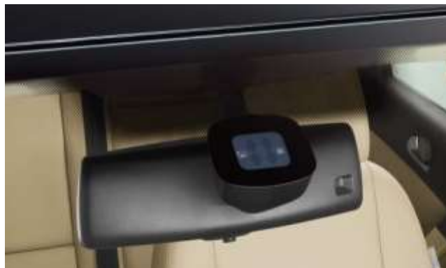
Figura 4 - Posição de montagem do sensor de chuva. Extraída de < http://www.jalopnik.com.br >.
