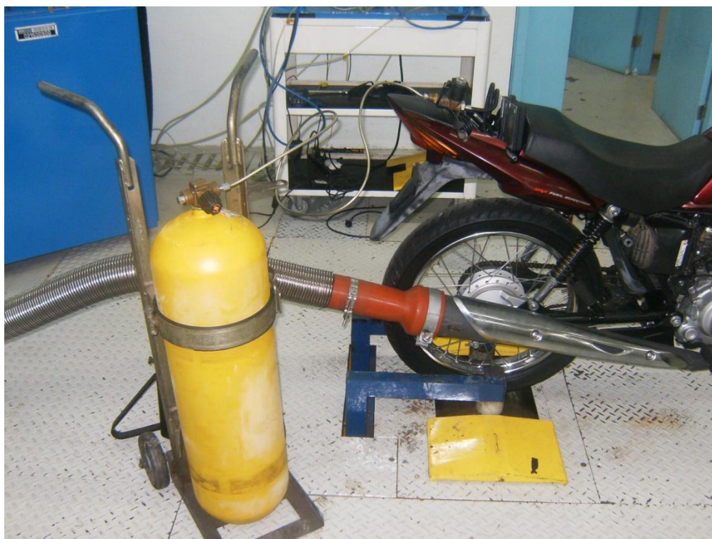
Figura 13 - Calibração do motor com cilindro 7,5m 3 externo .
