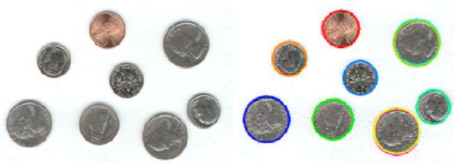
Figura 15: Aplicação de Hough para detecção dos círculos com múltiplos raios. (RHODY, H., 2005).
