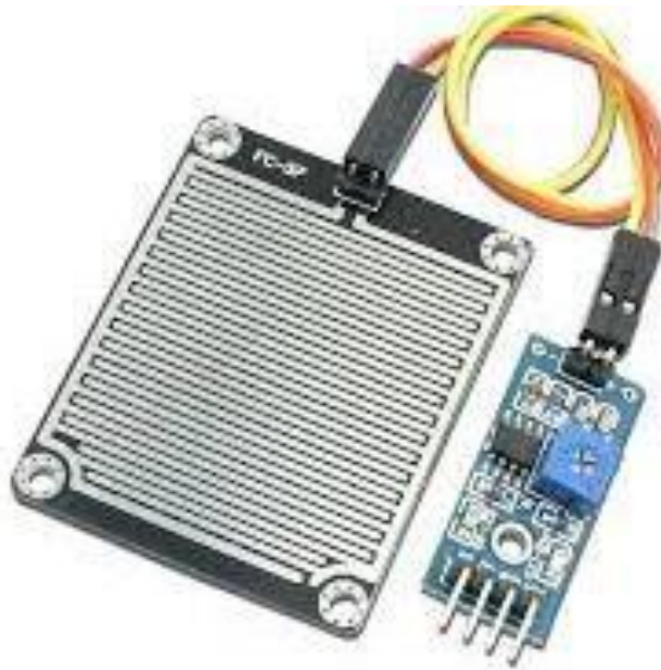
Figura 5 Imagem do shield sensor de chuva
