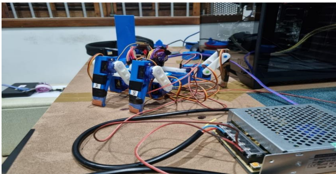
Figura 7- Robô Aranha com seus componentes conectados, e ligado á uma fonte- Fonte: Próprio Autor
