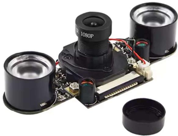
O Módulo de Câmera 5Mp Raspberry Pi possui uma Câmera Fisheye 5Mp OV5647, equipada com dois pequenos módulos Infravermelho que possibilita a visão noturna em ambientes totalmente escuros.
