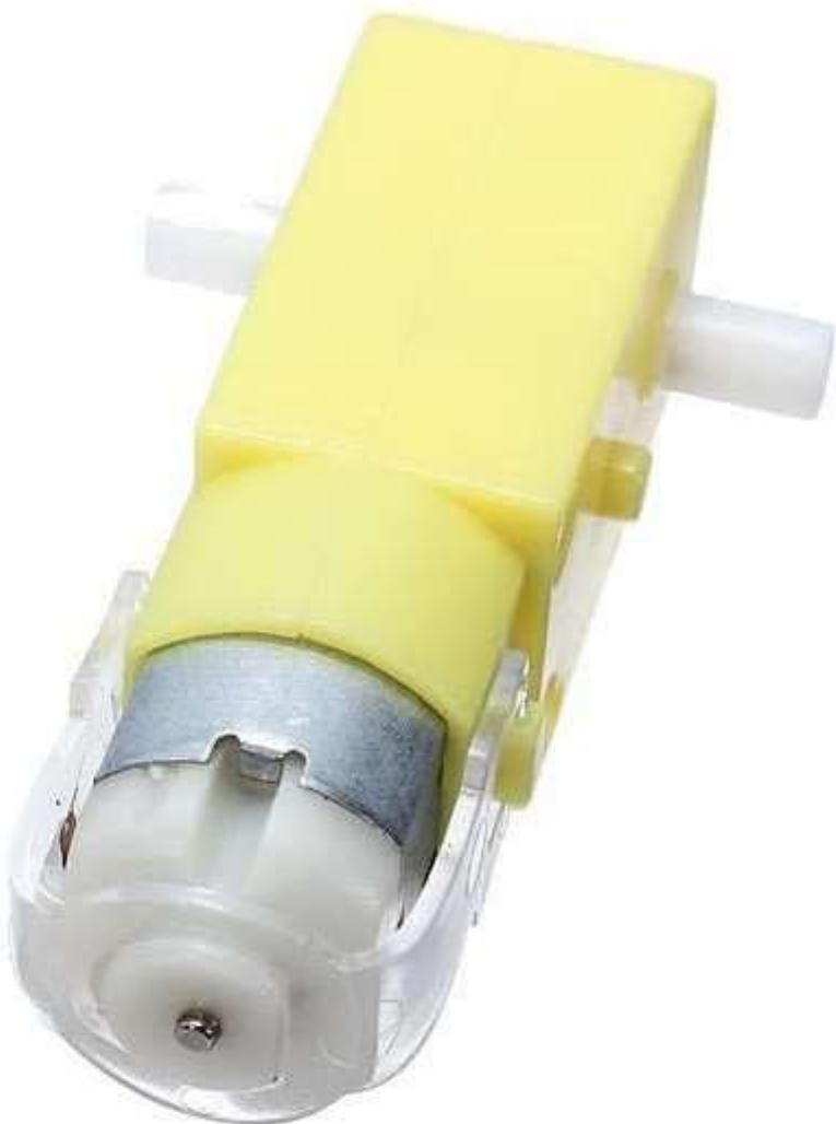
Este motor é uma opção barata e fácil de usar para adicionar movimento ao seu projeto. O conjunto possui um eixo de saída de 9mm. tensão de alimentação recomendada: 4,5V Corrente em aberto: 190 mA Corrente com máxima carga: 250mA Corrente de Stall: 1.2A @ 6V (0.6A @ 3V) Relação da caixa de redução: 48:1 Velocidade: 140RPM @ 4,5V sem carga Torque: 800 gf.cm
