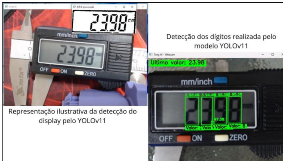
Figura 12 – Exemplo da detecção do display e dos dígitos utilizando YOLOv11.
