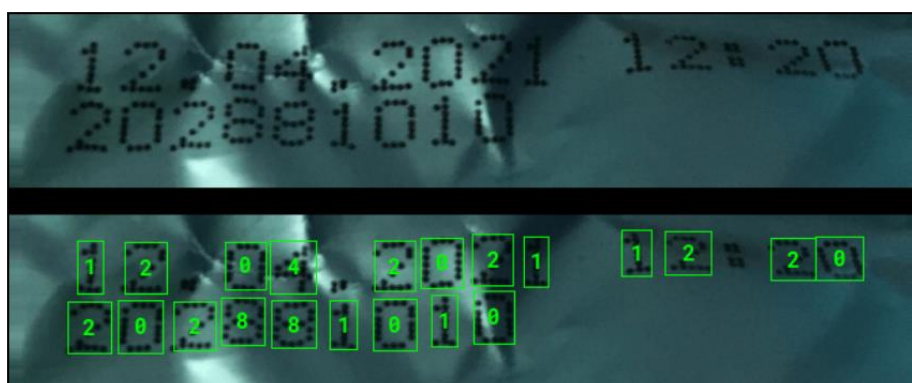
Figura 4 – Detecção e reconhecimento de caracteres utilizando YOLOv11 e OCR
