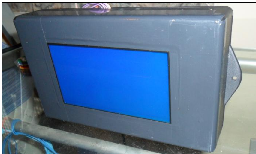
Figura 40: Display gráfico e circuito de controle instalados na caixa plástica (foto elaborada pelos autores, 2012).
