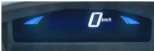
Figura 22: Velocímetro do Honda Civic 2012, que utiliza display numérico para indicação da velocidade (Figura elaborada pelos autores, 2012).
