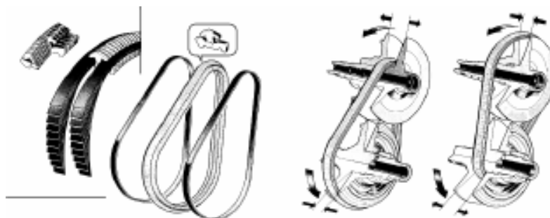
Figura 20 - Polias e cintas CVT (Extraído NAUNHEIMER et al., 2010)
