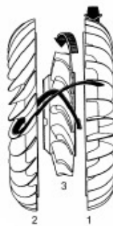
Figura 3 - Representação do vórtice no conversor de torque
