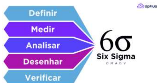
Figura 5 - Esquema do método DMADV
