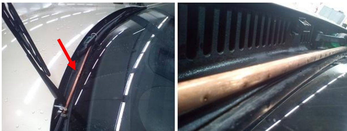
Figura 37 - Sistema montado, com tubo posicionado na base do para-brisa (Ilustração elaborada pelo autor)
