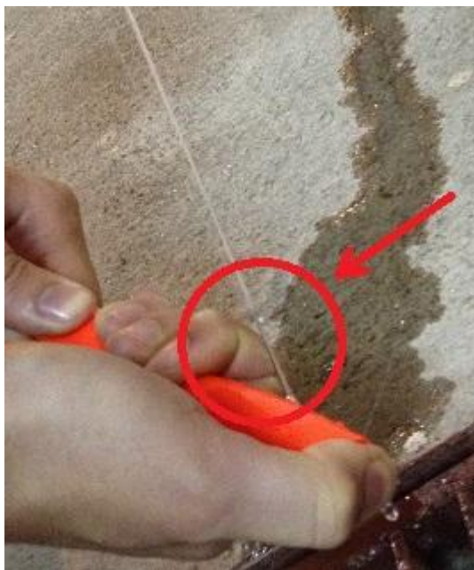
Figura 31 - Teste com agulha vazada inserida no orifício da mangueira (Ilustração elaborada pelo autor)
