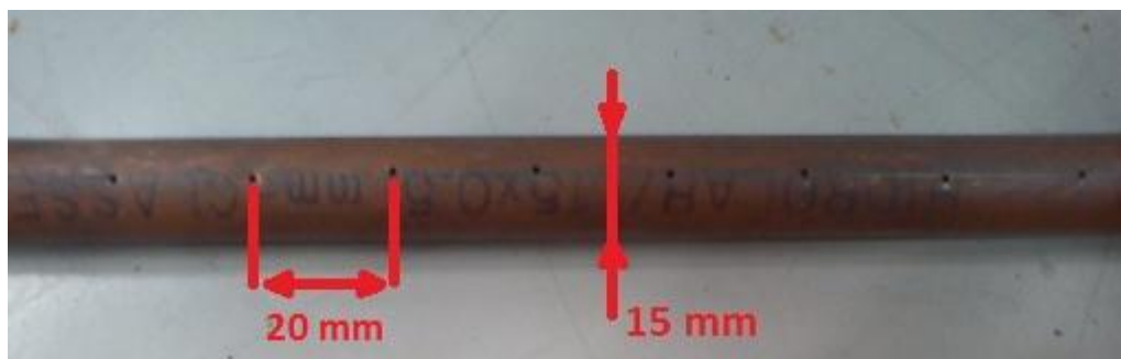
Figura 35 - Tubo de 15 mm de diâmetro e 56 furos espaçados de 20 em 20 mm, utilizado no terceiro teste (Ilustração elaborada pelo autor)
