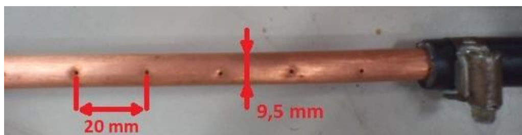
Figura 33 - Tubo de 9,5 mm de diâmetro e 40 furos espaçados de 20 em 20 mm, utilizado no primeiro teste. Este é similar ao utilizado no quarto teste (Ilustração elaborada pelo autor)
