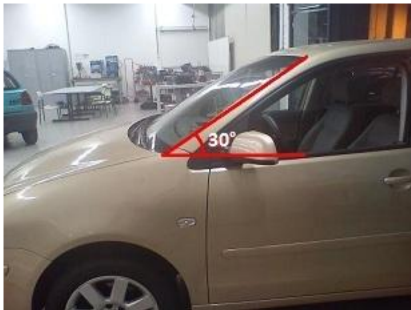
Figura 36 - Veículo utilizado nos experimentos, cujo para-brisa possui dimensões e posicionamento condizentes com os veículos da atualidade (Ilustração elaborada pelo autor)
