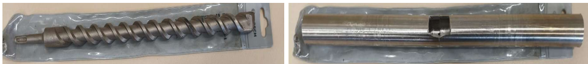
Figura 4 – A) Broca de concreto, B) Canhão de extrusão torneado
