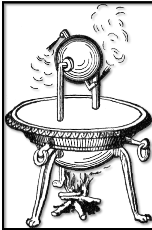
Figura 1 - Eolípila ou Máquina Térmica de Heron
