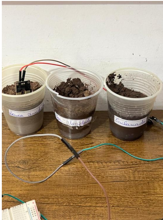
Figura 17: Fiação sensor de umidade
