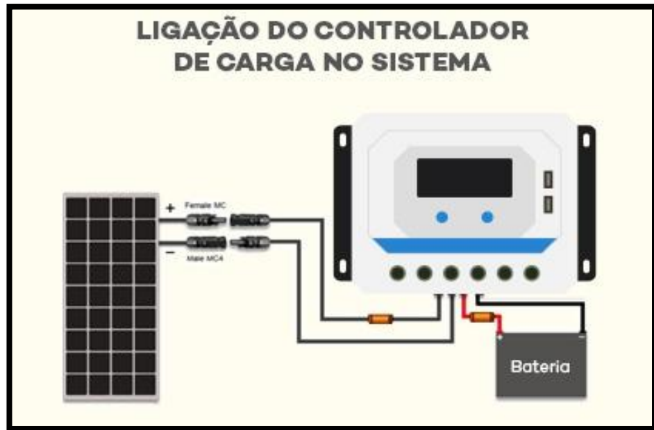
Figura 7- Sistema fotovoltaico off-grid utilizando regulador de carga.
