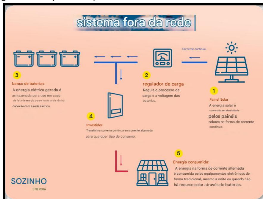
Figura 2 – Representação de um sistema fotovoltaico OFF Grid.
