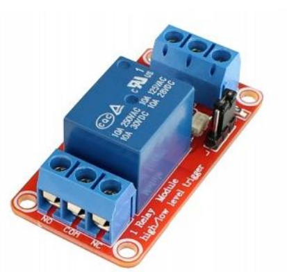
Figura 3 - Módulo Relé 5V 10A 1 Canal com Optoacoplador
