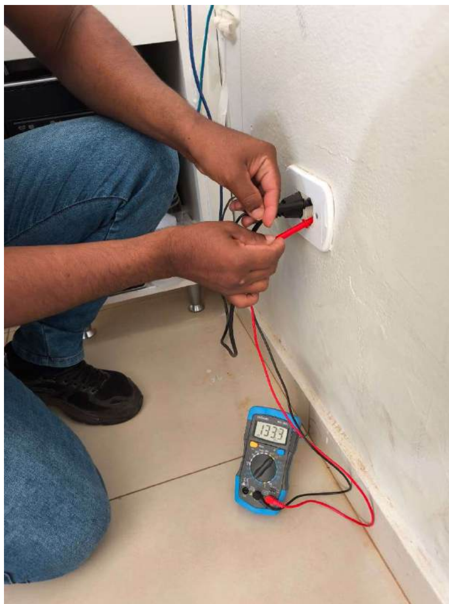
Figura 11: Medições de tensão
