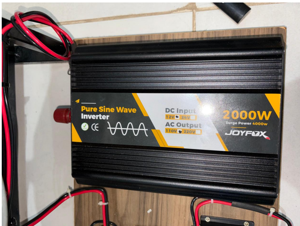
Imagem 25: Inversor de Tensão 12 Vcc/110 Vac
