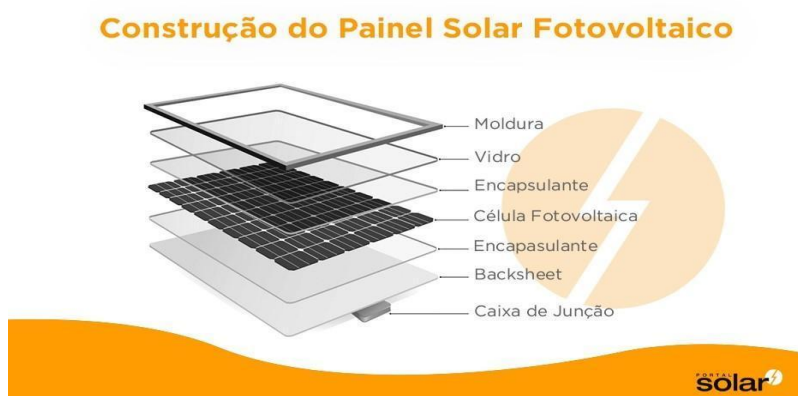
Figura 7 – Construção do painel solar fotovoltaico
