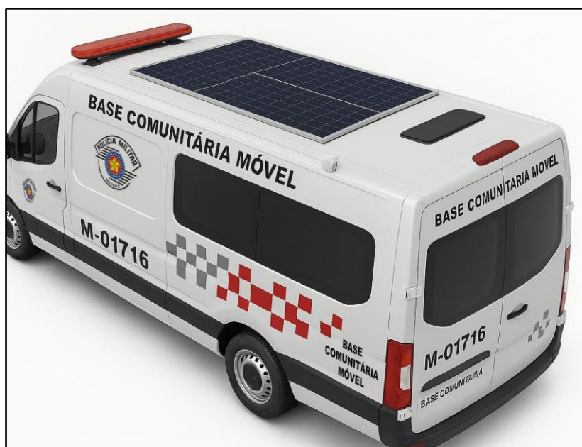
Figura 17 – Sugestão de montagem das placas
