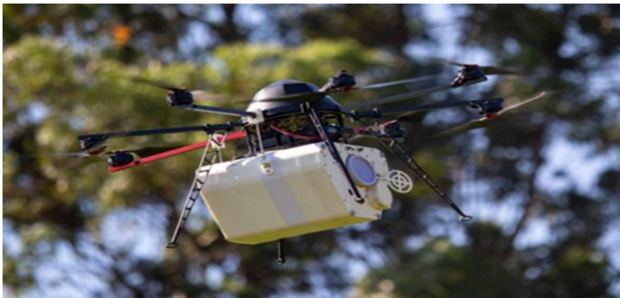
Figura 6. Mecanismo liberador de capsula fixado na ARP.
