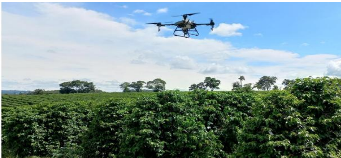
Figura 5. ARP multi- rotor utilizado em experimento de pulverização para controle da broca-do- café.
