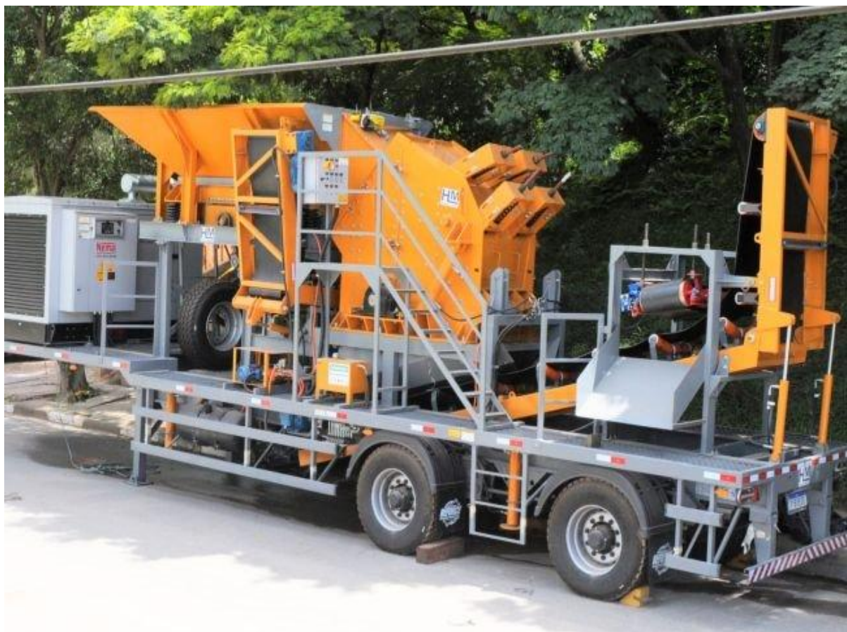
FIG 1 – Triturador Móvel de RCC
