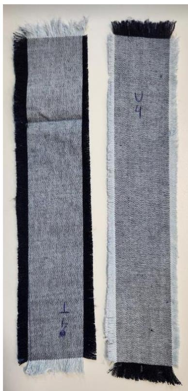
Condicionamento das amostras: antes dos ensaios visando minimizar variações nos resultados, as amostras ficaram acondicionadas longe de fontes de calor, umidade na média de 80% e temperaturas entre 16 °C a 21 °C.
