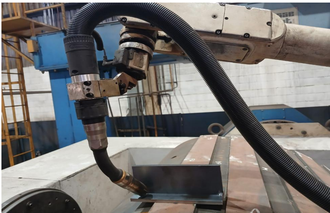
Fig.15 Posição 2F Com Robô.
