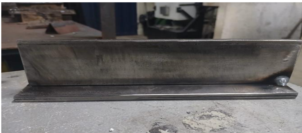
Fig.12 Corpo De Prova (CP), (Junta em ângulo 6mm x 6mm)
