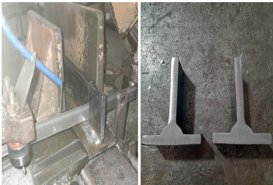
Fig.9 Etapa De Corte e Lixamento Para Análise Macrografia.
