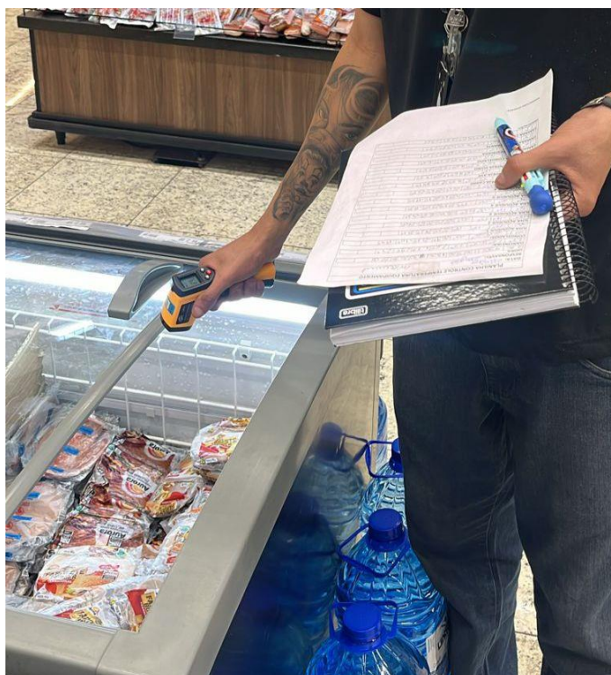
Figura 2: Funcionário medindo a temperatura do equipamento.
