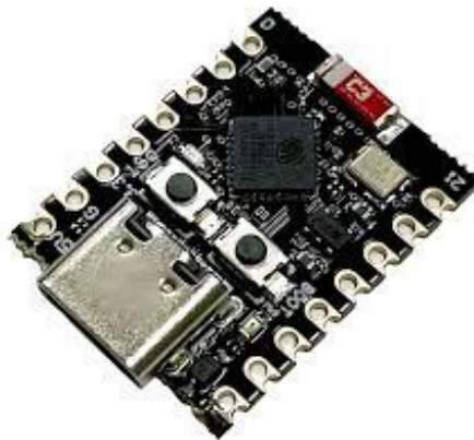
Figura 7: Microcontrolador produzido pela Espressif
