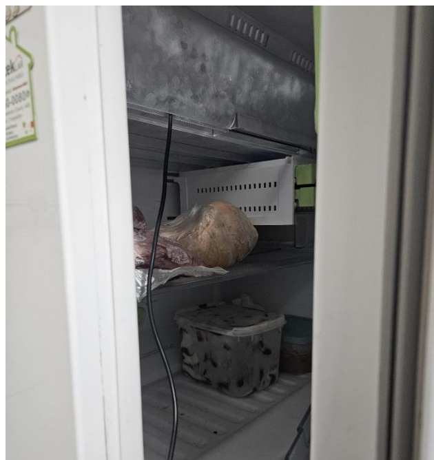
Figura 27: sensor de temperatura do dispositivo inserido no freezer.
