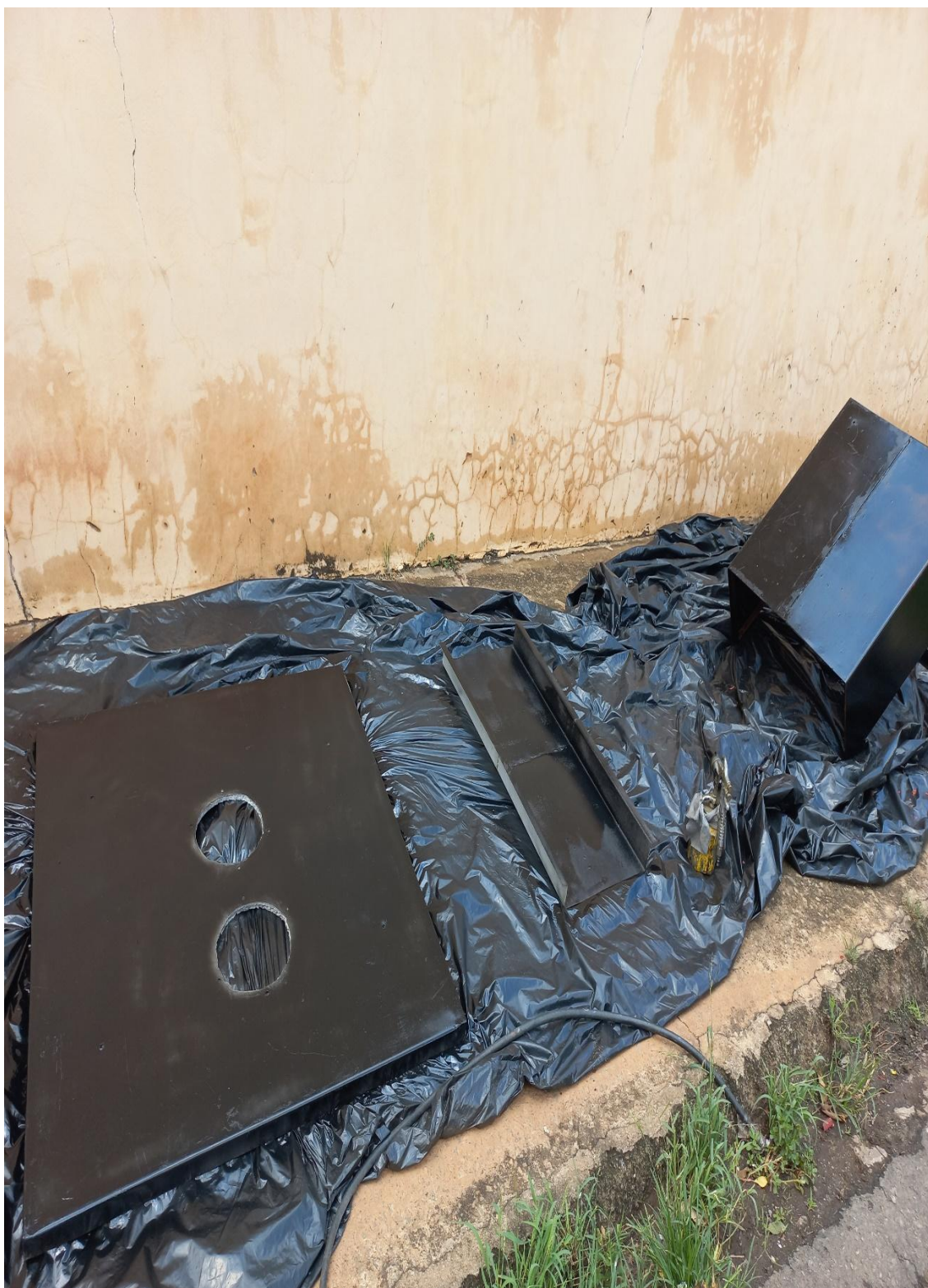
Figura 28-Pintura do teto e capô
