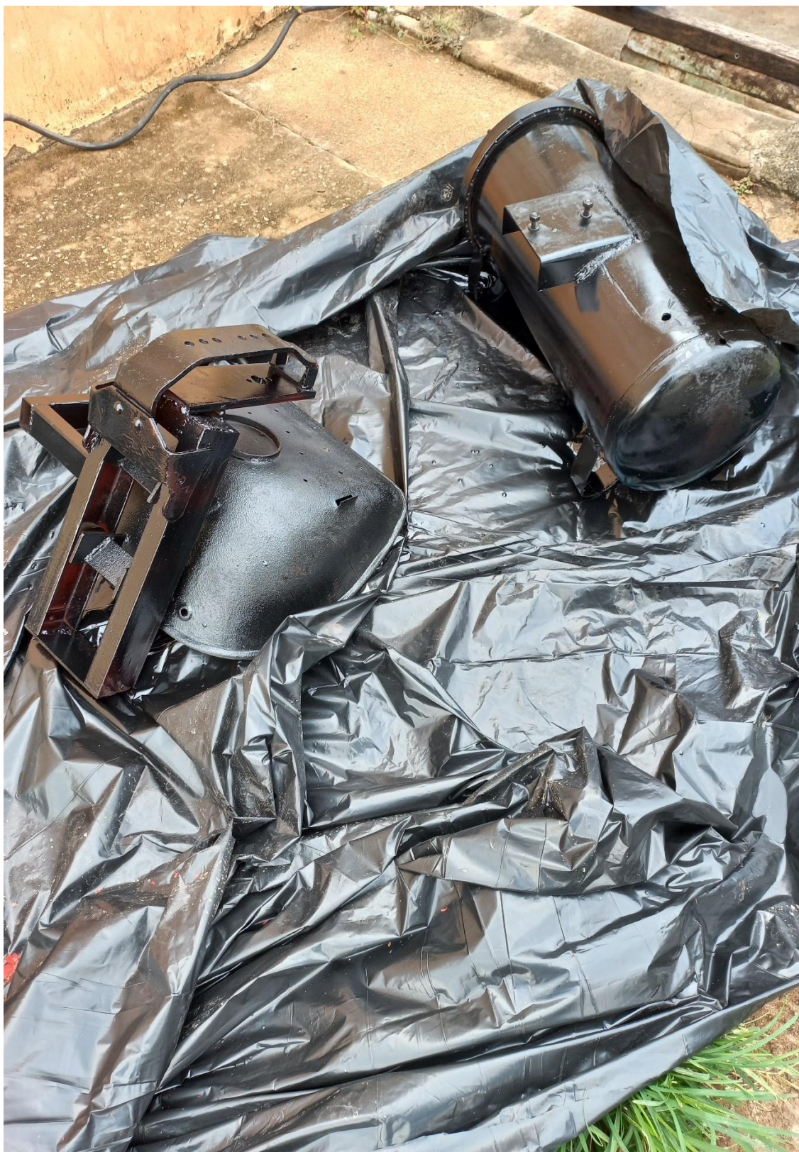
Figura 27-Pintura do reservatório hidráulico e banco
