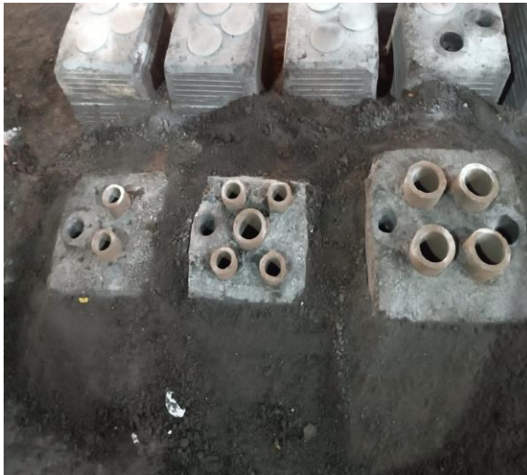
FIGURA 3 – Moldagem do bloco
