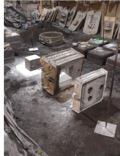
FIGURA 4 – Moldagem do bloco
