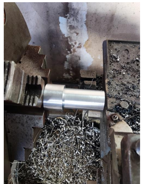
FIGURA 12 – Torneamento do braço do virabrequim
