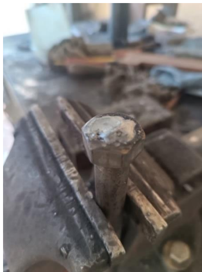
FIGURA 18 – Solda da cabeça do parafuso
