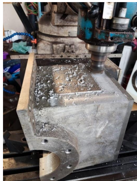
FIGURA 14 – Usinagem do bloco
