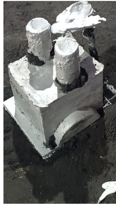
FIGURA 6 – Desmolde do bloco
