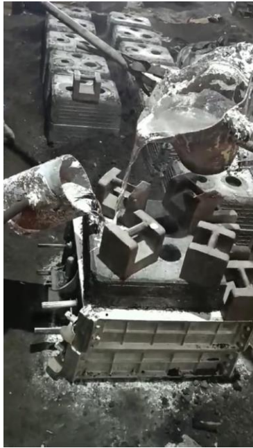
FIGURA 5 – Fundição do bloco
