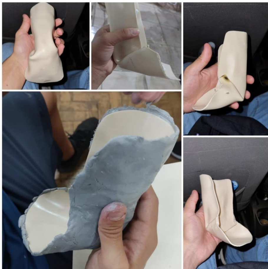
Figura 6 – Aplicação da massa adesiva
