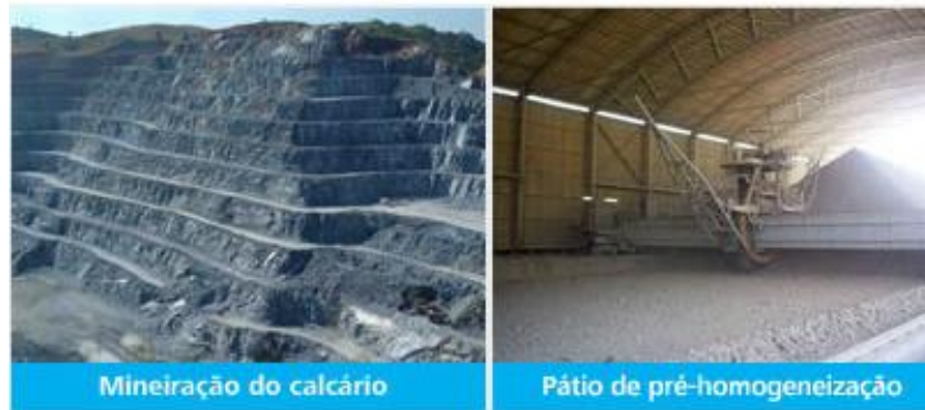
Figura 1 – Jazida a céu aberto e pátio de pré-homogeneização.
