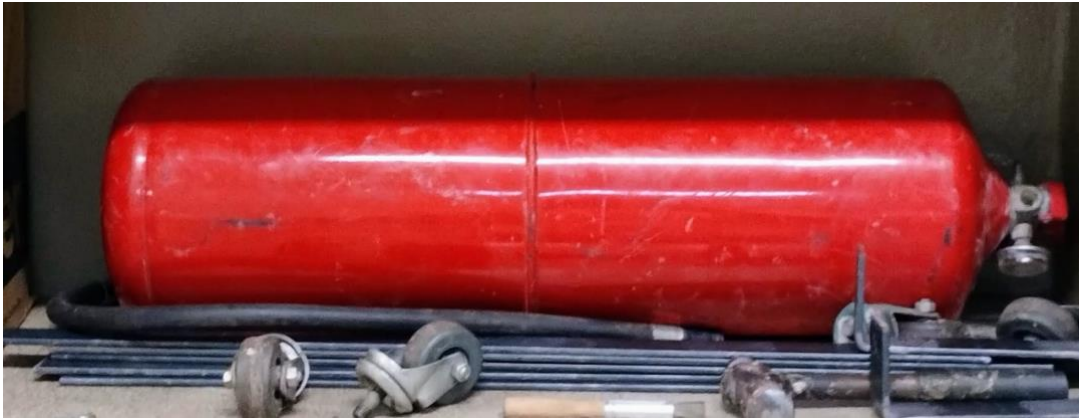
Figura 1 Extintor usado servindo de cilindro do compressor em sua forma inicial para o projeto. Fonte própria
