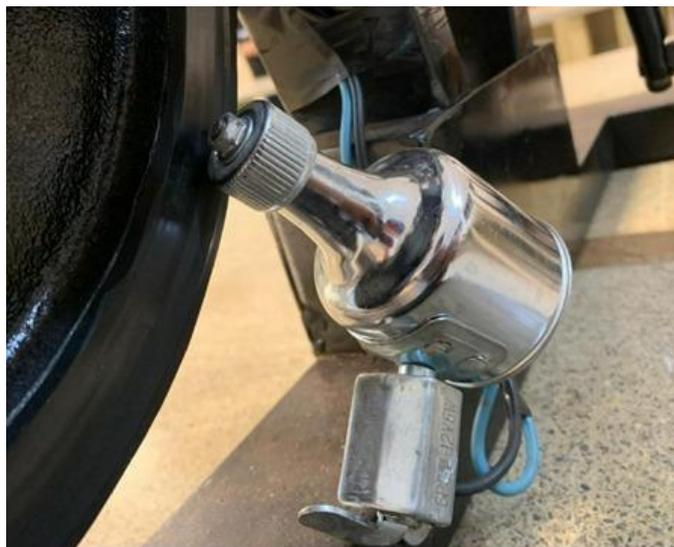
FOTO 9: DÍNAMO INSTALADO NA BASE
