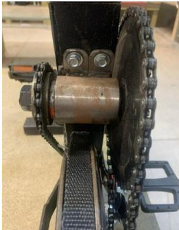
FOTO 5: ADAPTAÇÃO DO SISTEMA MULTIPLICADOR DE ROTAÇÃO
