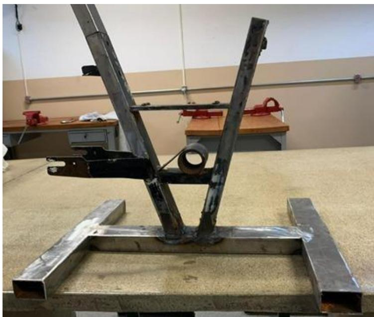
FOTO 3: ESTRUTURA APÓS O PROCESSO DE LIXAMENTO
