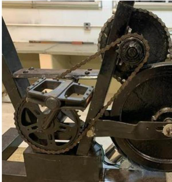
FOTO 6: INSTALAÇÃO DA NOVA COROA E CATRACA
