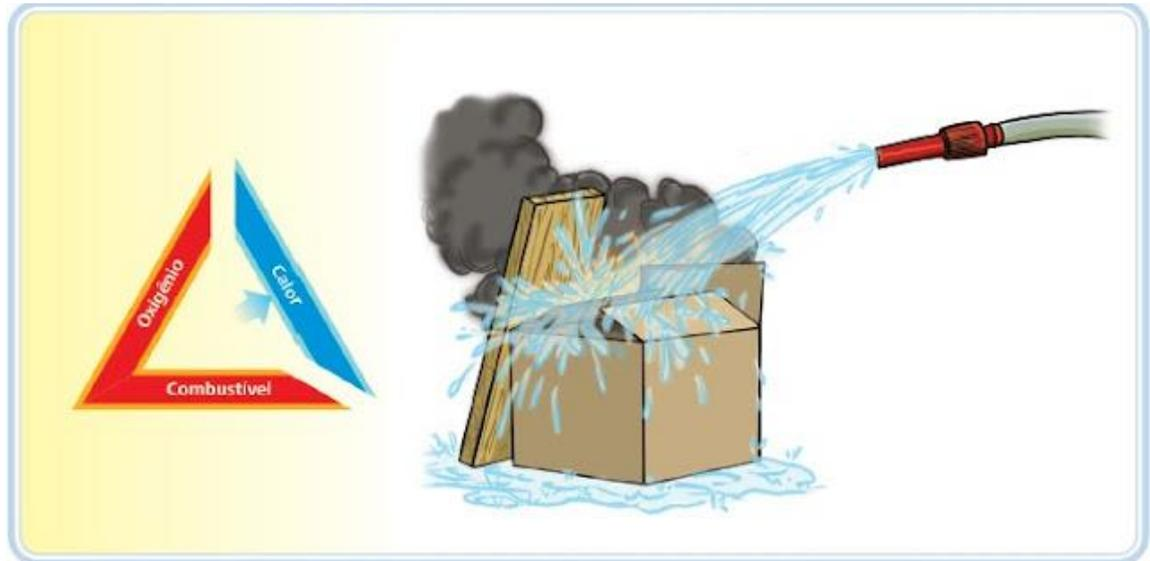
Figura 12: Método de prevenção e/ou combate por resfriamento - Fonte: CTISM
