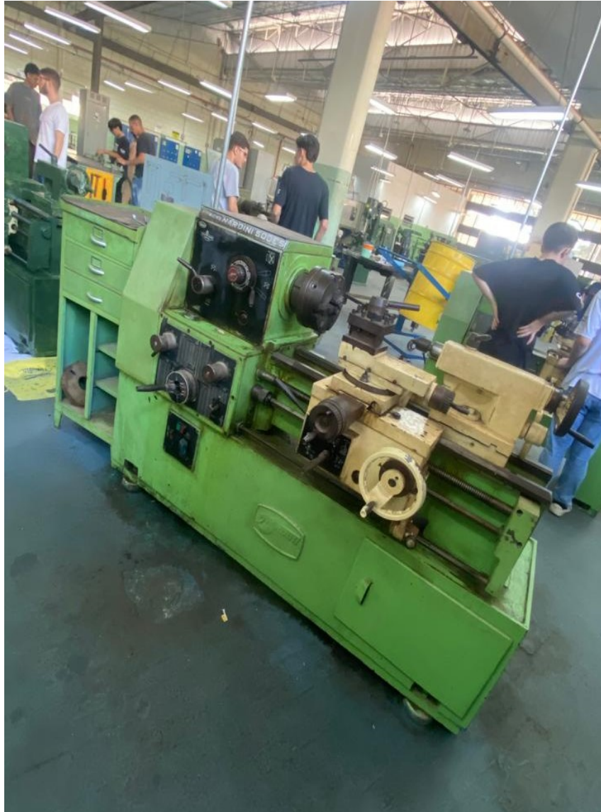
Figura 1 – Torno antes da reforma
