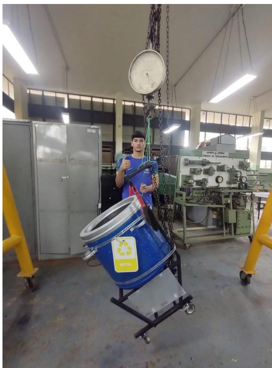
Fotografia 22 – Pesagem do Poslo finalizado na balança de carga no pórtico
