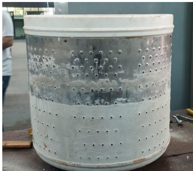
Fotografia 5 – Lateral do cesto de inox antes da limpeza
