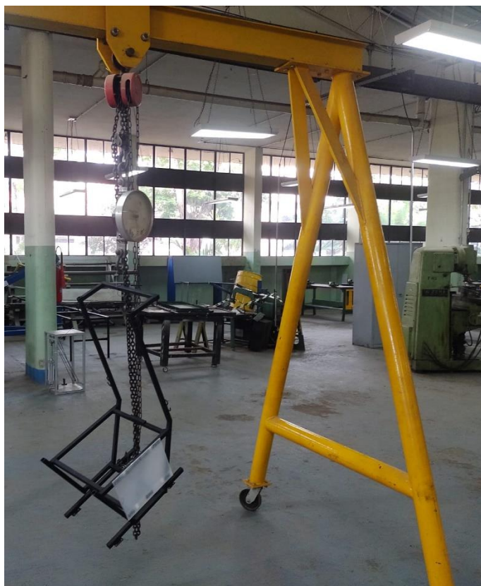
Fotografia 13 – Pesagem da estrutura na balança de carga presa ao pórtico
