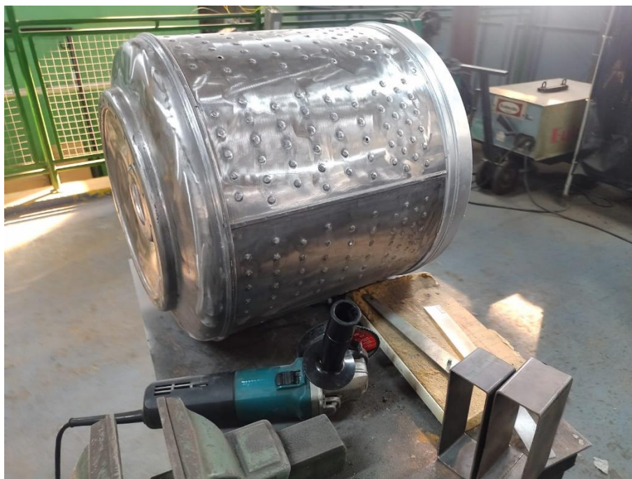
Fotografia 10 – Cesto de inox após o preparo de sua superfície para a pintura
