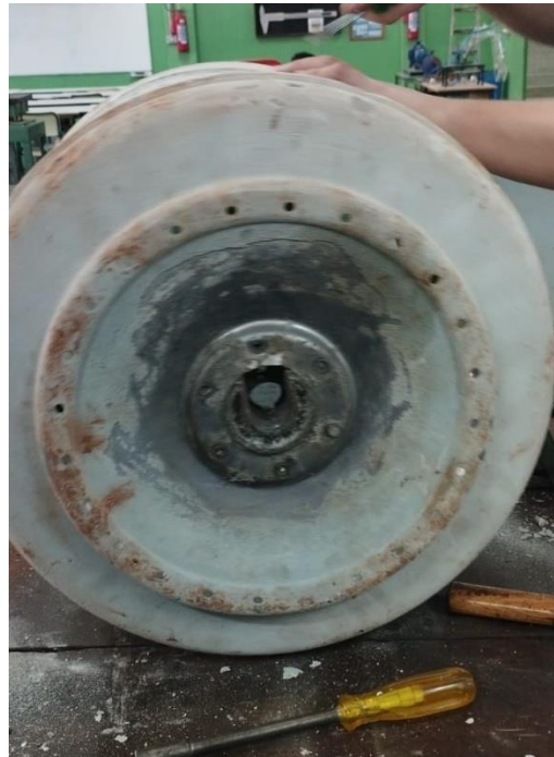
Fotografia 4 – Parte inferior do cesto de inox antes da limpeza
