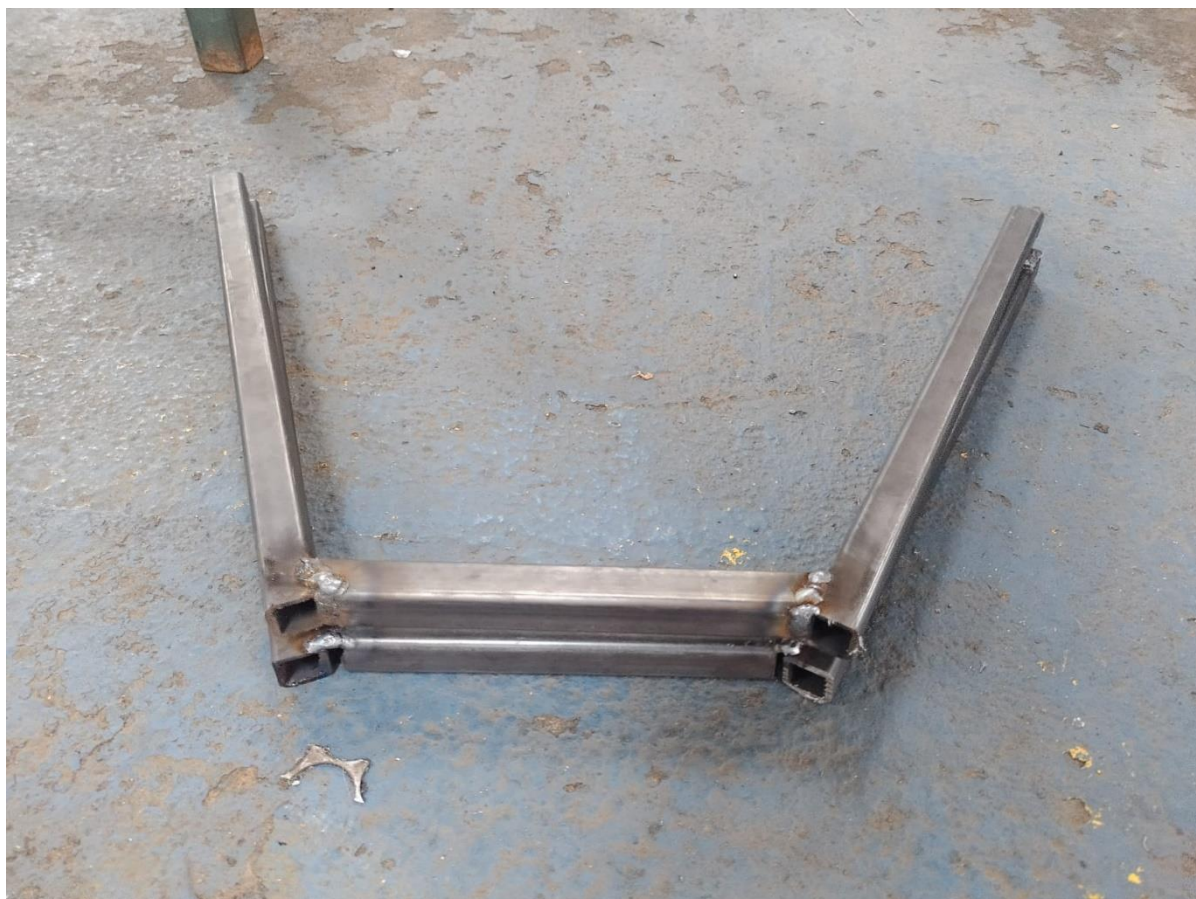
Fotografia 7 – Barras do tipo um soldadas nas do tipo dois, laterais da estrutura
