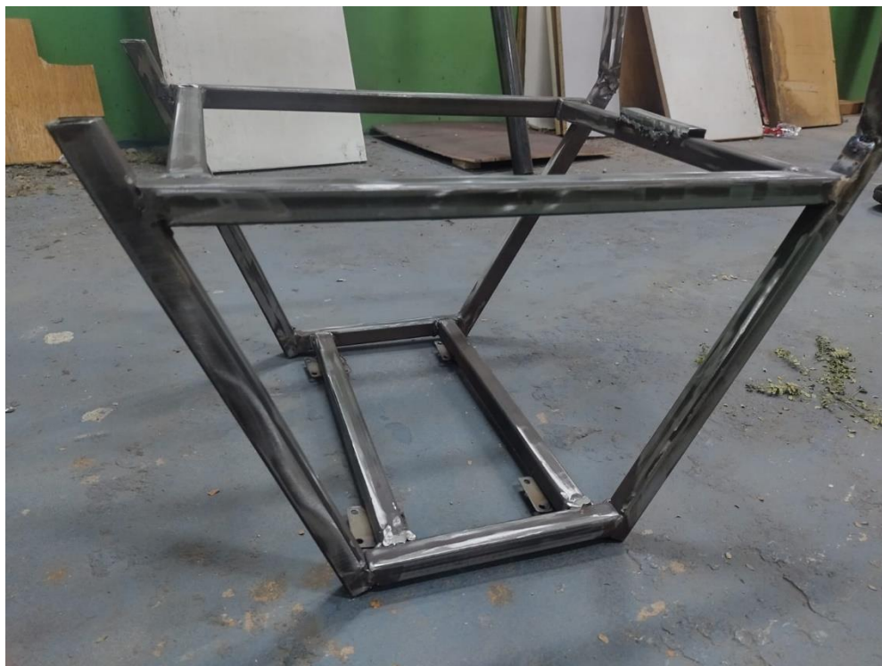
Fotografia 9 – Estrutura após o preparo de sua superfície para a pintura
