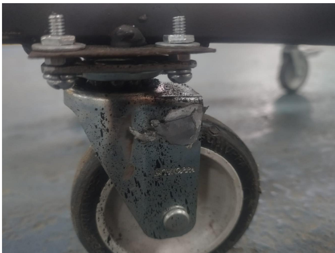
Fotografia 15 – Roda frontal com oito porcas para conseguir tocar o chão
