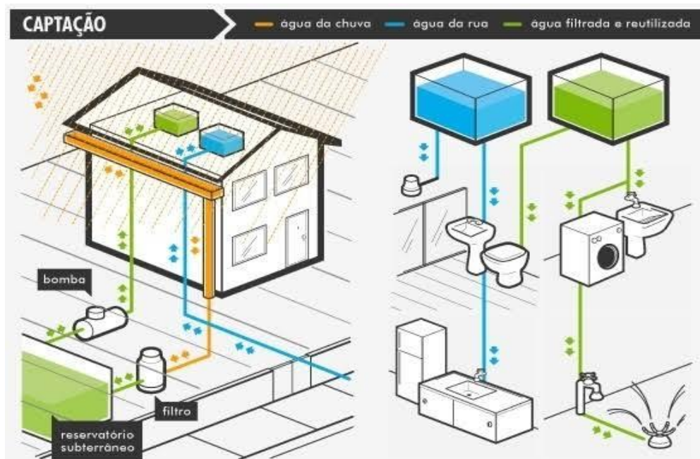
Figura 4: Captação, Armazenamento e Distribuição de Água de Reúso Fonte: Estilo-Casa e Imóveis (2010)
