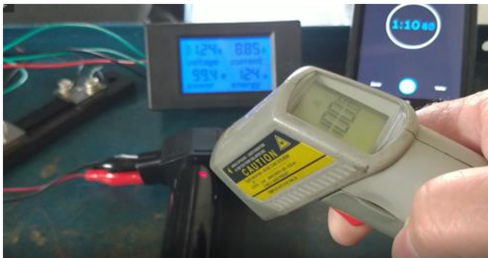
Figura 16 - Medição de temperatura no teste de resistência das bobinas
