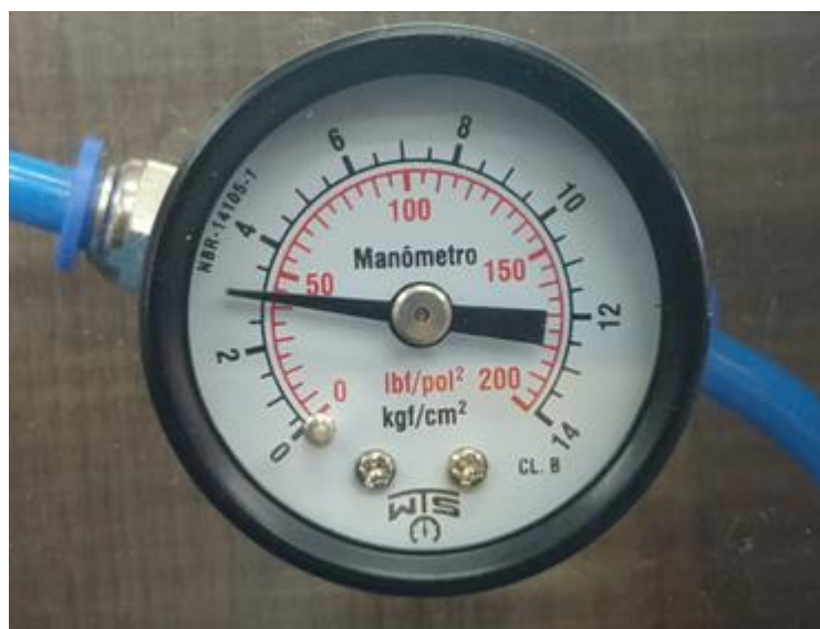
Figura 21 - Manômetro de pressão, marca WTS
