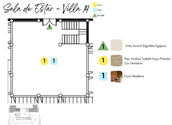
Figura 72 - Revestimentos Sala Villa 14, Pavimento Superior
