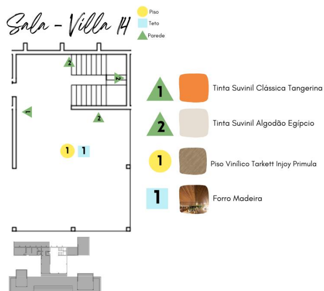
Figura 54 - Revestimentos Sala Villa 14, Pavimento Inferior
