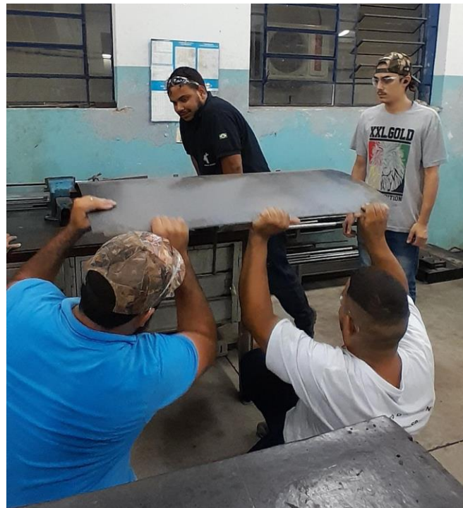
Figura 2 – DOBRA MANUAL DA CHAPA Fonte: Arquivo pessoal
