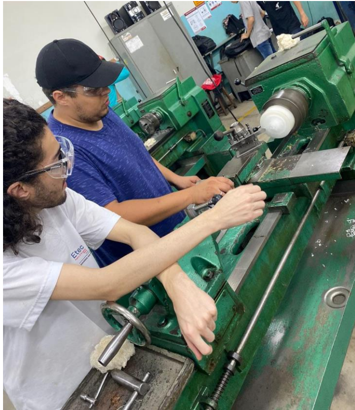
Figura 9 – USINAGEM DO BLANQUE Fonte: Arquivo pessoal
