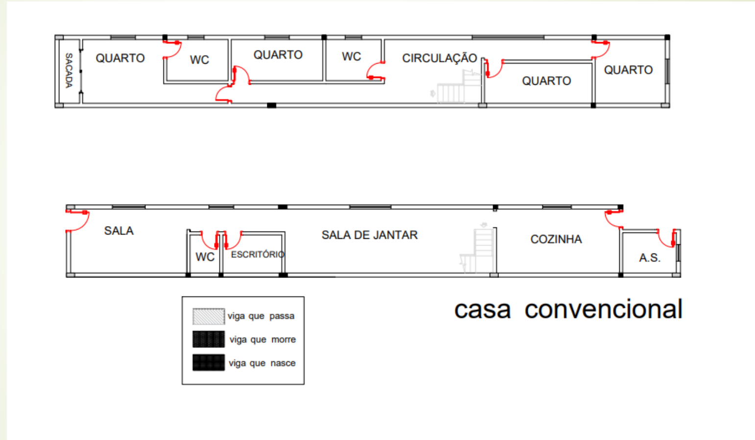
Figura 16: Planta baixa: vigas
