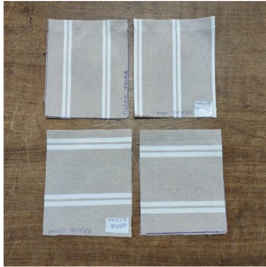
Figura 17: Tecidos preparados para o teste de esgarçamento
