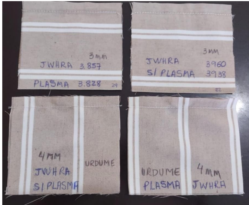
Figura 22: Teste de esgarçamento no tecido com amaciante
